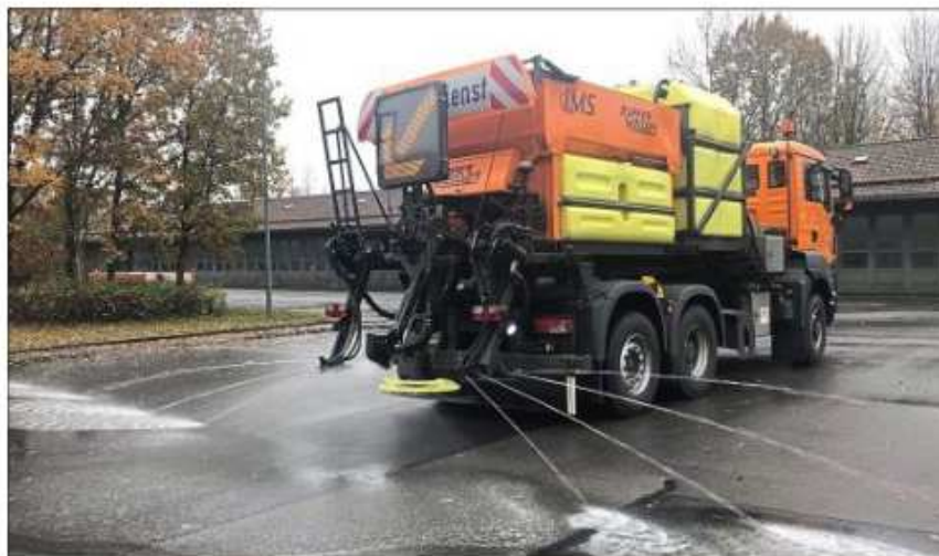
Drei solcher Streufahrzeuge mit moderner Solesprühetechnik warten in Kirchroth auf ihren Einsatz auf der Autobahn.
