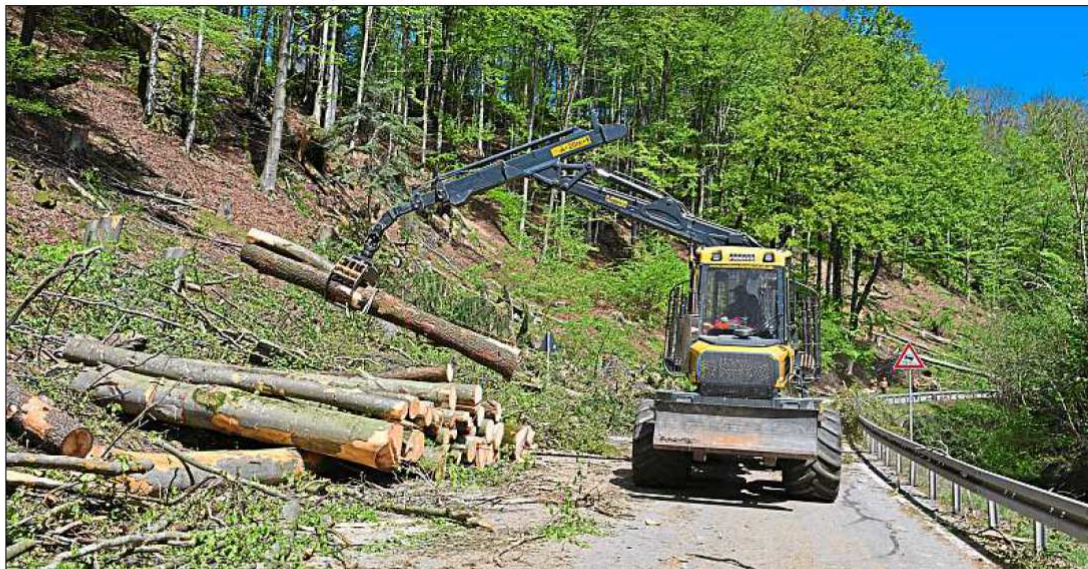
Mit dem Rückezug werden die Baumstämme am Fahrbahn gelagert, bis sie abtransportiert werden.
