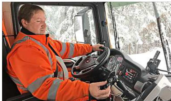
Mittels Drehknöpfe kann Stefan Madl die Streustärke und -breite des Salzes je nach Bedarf regulieren. – Fotos: Aicher
